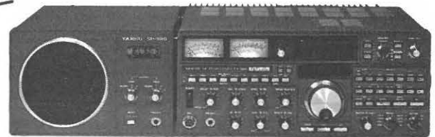
FT 980 - Emetteur bandes amateurs, récepteur toutes bandes. Entrée ordinateur.
